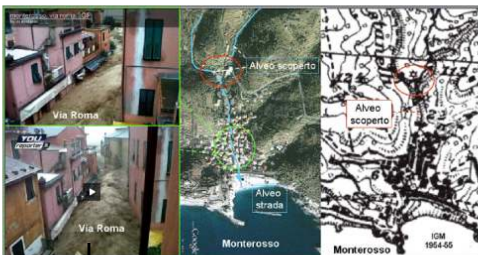
Figura 3: A destra l'abitato di Monterosso nel 1954-55 quando l'alveo era ancora in gran parte scoperto. Al centro: l'alveo trasformato in alveo-strada (chiamata via Roma) che è stato devastato dal flusso fangoso-detritico che si è riappropriato dell'area di sua competenza
