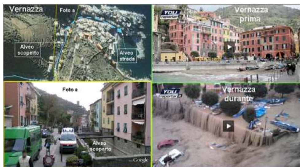
Figura 2: In alto a sinistra: l'alveo strada che attraversa l'abitato di Vernazza; in basso a sinistra: l'alveo scoperto a monte dell'abitato. La sezione si è rivelata mal dimensionata ed insufficiente a smaltire il flusso fangoso-detritico che ha invaso la sovrastante strada devastandola
